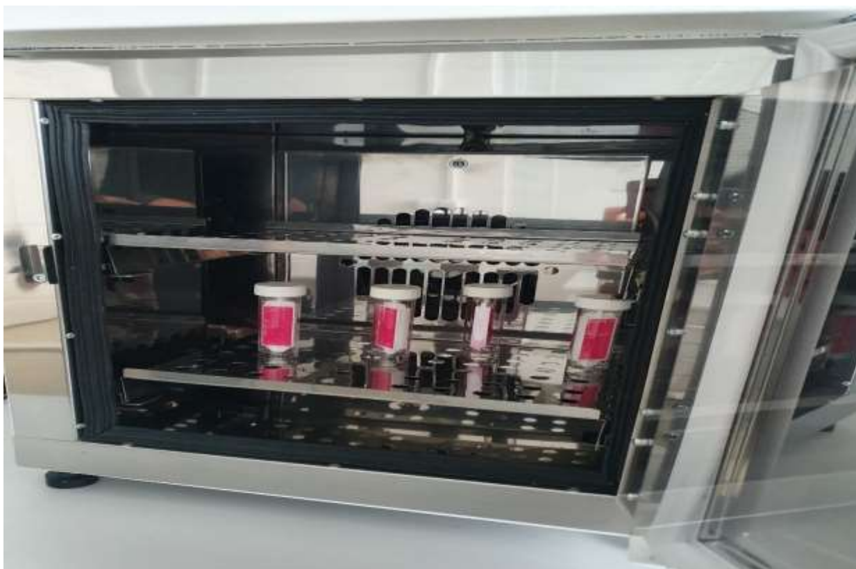
Рис. 2.2.4. Термостат ТОВ «МІЗ-МА» ТС-20 клас І типу В. ДСТУ EN 60601-1:2015. ТУ У 26.5-31411528-01:2016 для зберігання тестерів
