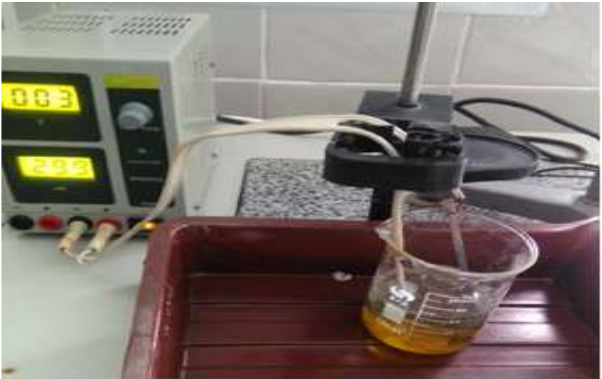
Рис. 2.2.3. Установка для проведения электрохимического синтеза препаратов на основе комплексов «хитозан-мідь»
