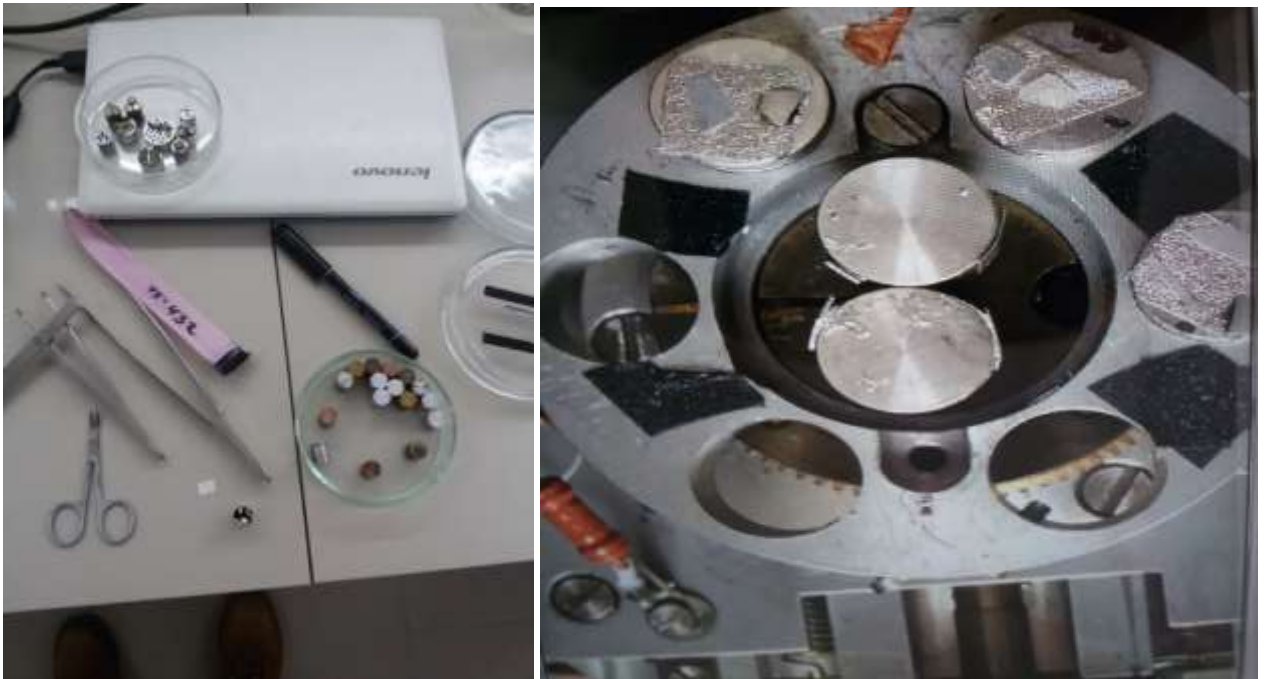
Рис. 2.2.8. Підготовка та напилювання срібла на зразок шкаралупи яєць
