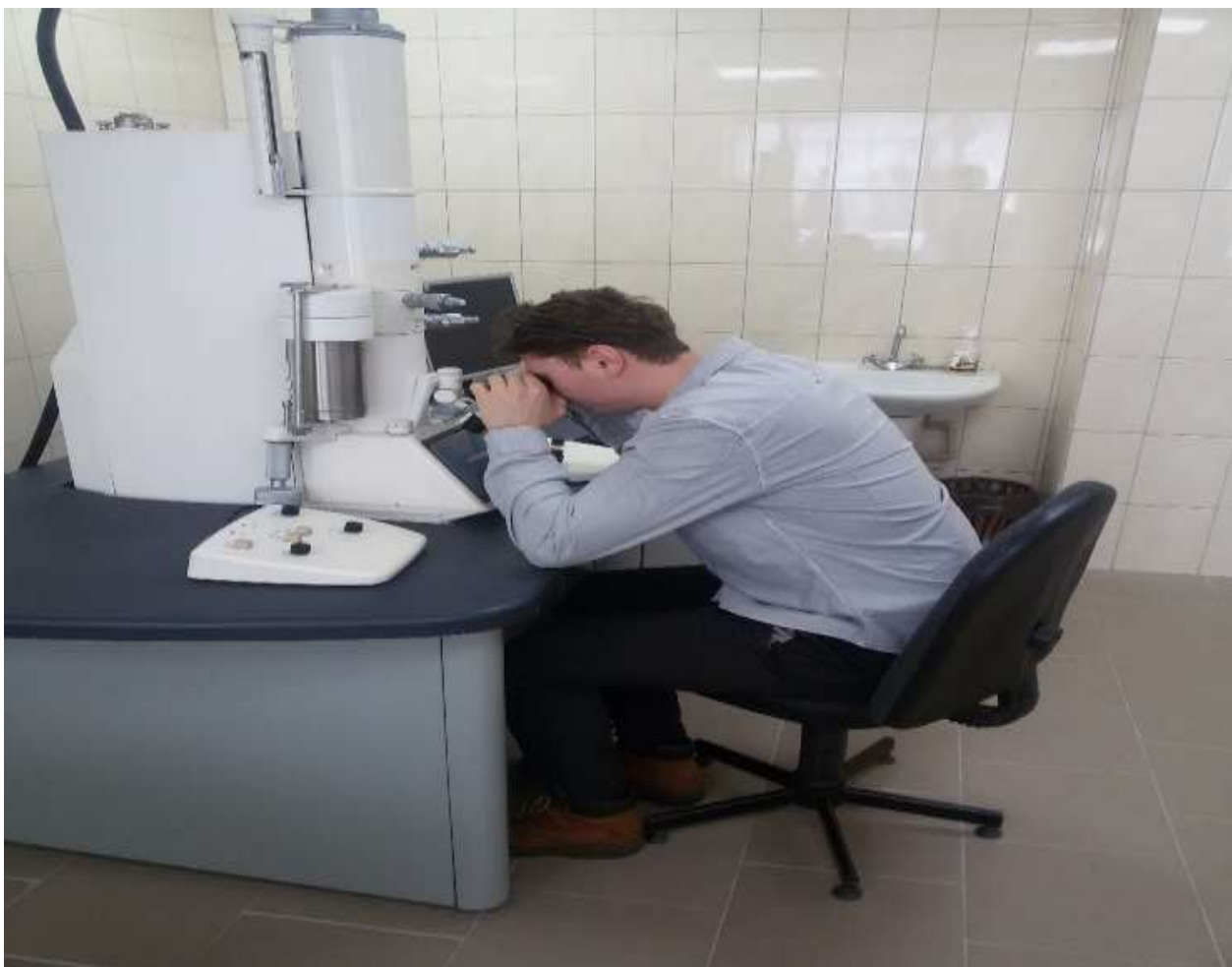
Рис. 2.2.6. Дослідження методом скануючої електронної мікроскопії з використанням електронного мікроскопа «РЕММА-102»
