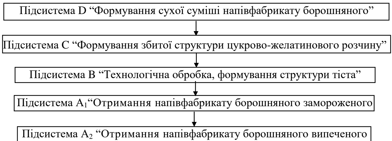
Рис. 4.1 Модель технологічної системи виробництва напівфабрикату борошняного збивного
