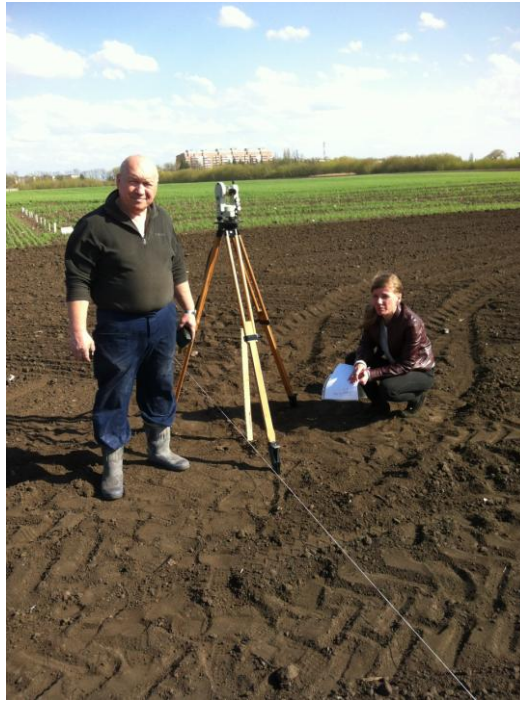
Рисунок 3.4 – Визначення положення вішок за допомогою теодоліта Т30
