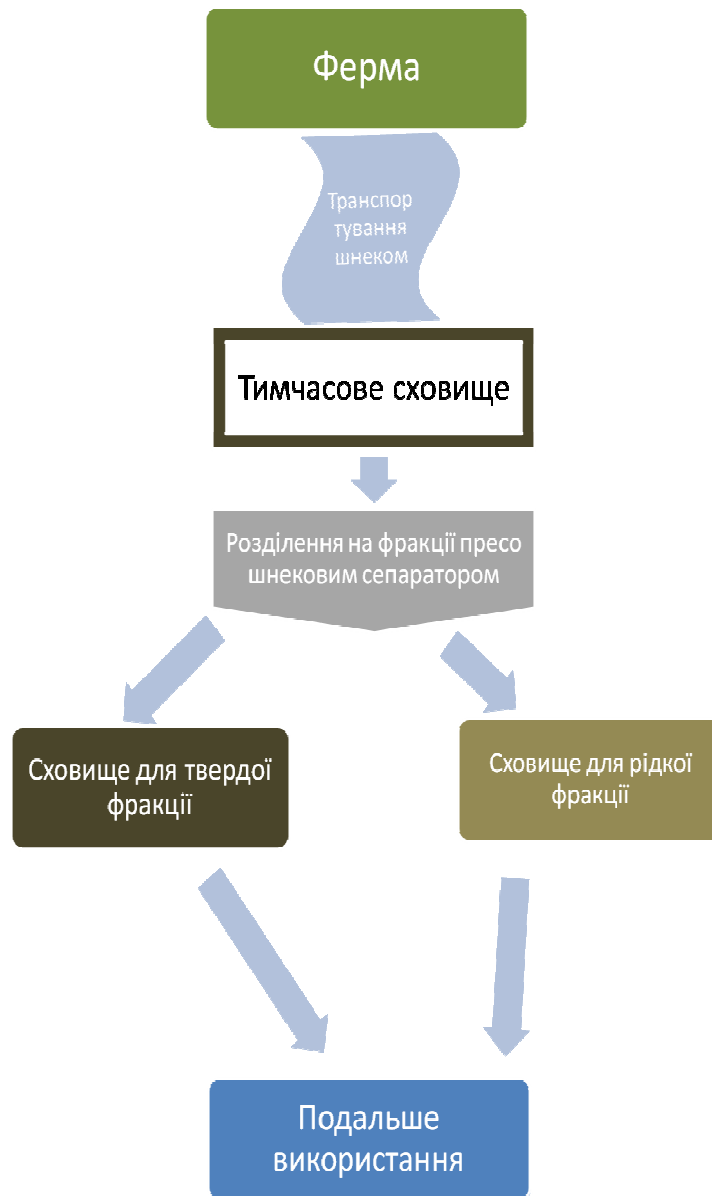
Рисунок 1.1 - Технологічний цикл видалення та утилізації гною
