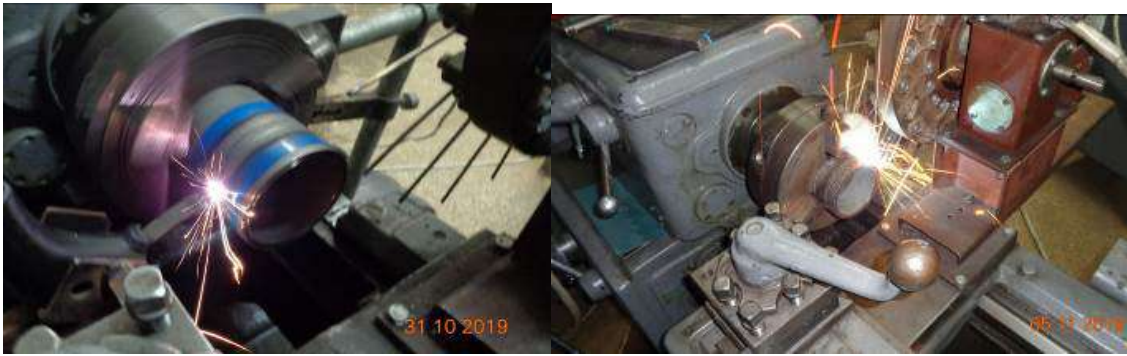
Рисунок 5.4 –ЦЕІЛ ( а ) і ЕІЛAl ( б ) поверхні труби
