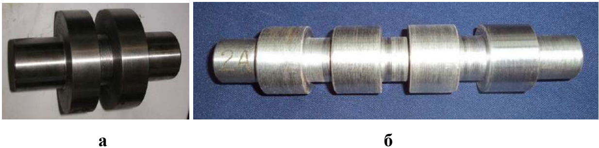
Рисунок 3.6 –Зразки з корозійно-стійких нержавіючих сталей 12Х18Н10Т і 10Х17Н13М2Т для нанесення КЕП.
