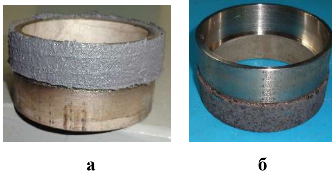
Рисунок 3.10 – Відрізана ділянка труби: а - з нанесеним МПМ, армованим порошком у вигляді твердосплавної суміші ВК6; б - з проточеним МПМ.
