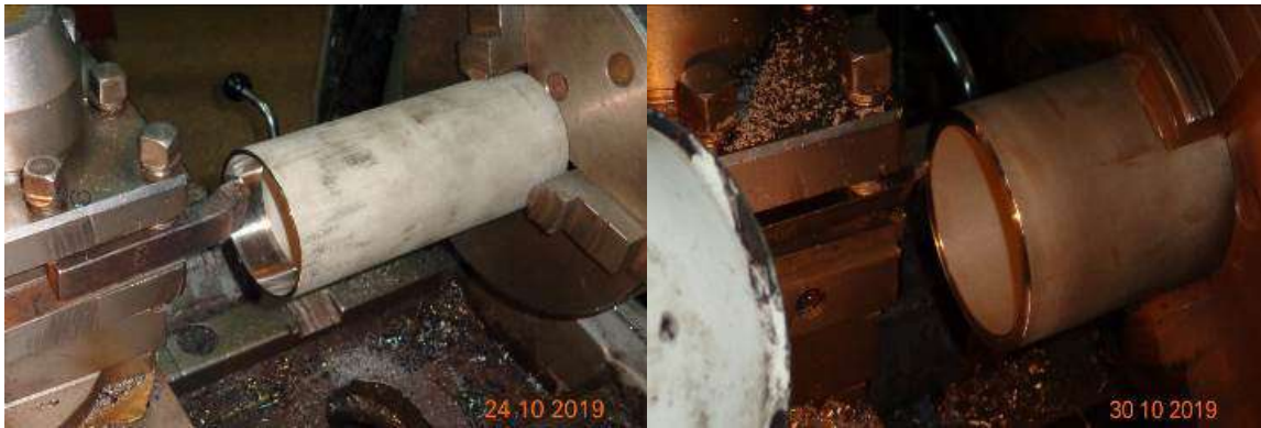
Рисунок 5.3 –Виготовлення виточки ( а ) і паза ( б ) в трубі
