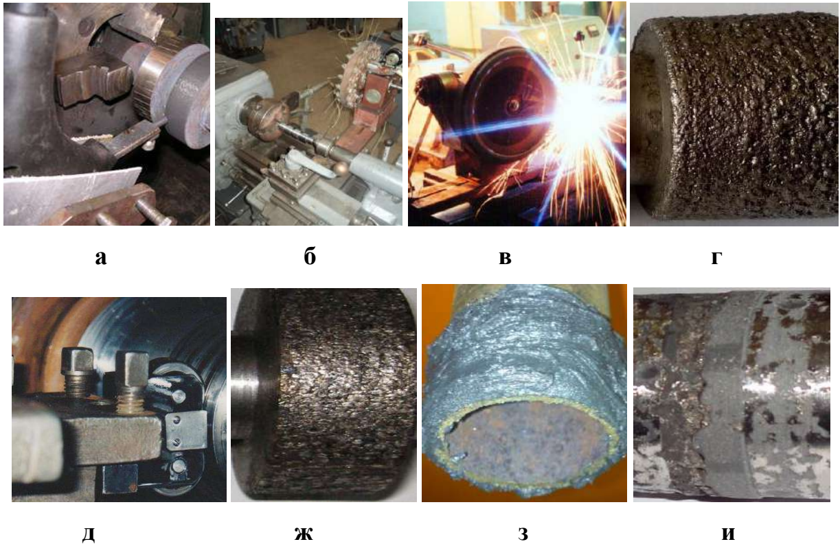
Рисунок 3.7 – Формування на сталі 12Х18Н10Т КЕП: а -ЦЕІЛ; б - ЕІЛ А1; в - ЕІЛ Т15К6; г - поверхня зразка з КЕП; д - ОК; ж - поверхня зразка після ОК; з - поверхня зразка з МПМ, армованим твердим сплавом ВК6, и - проточена поверхня зразка.
